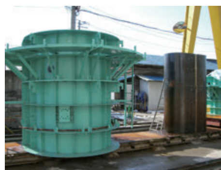
鋼製型枠(PCウェル)
