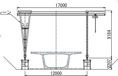
主桁製作台断面図
