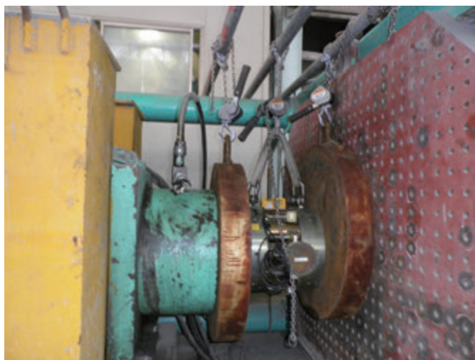
同時緊張機(P C工場)のキャリブレーション
