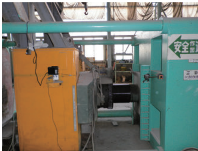
伸び計(P C工場)のキャリブレーション
