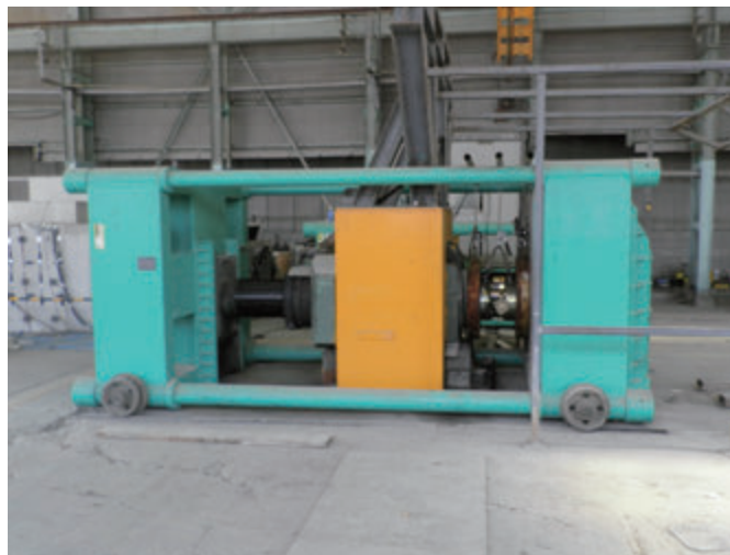
同時緊張機(P C工場)のキャリブレーション
