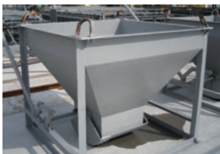
コンクリートバケット
