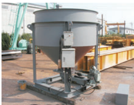
コンクリートバケット
