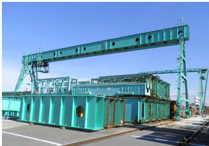
橋形クレーン
