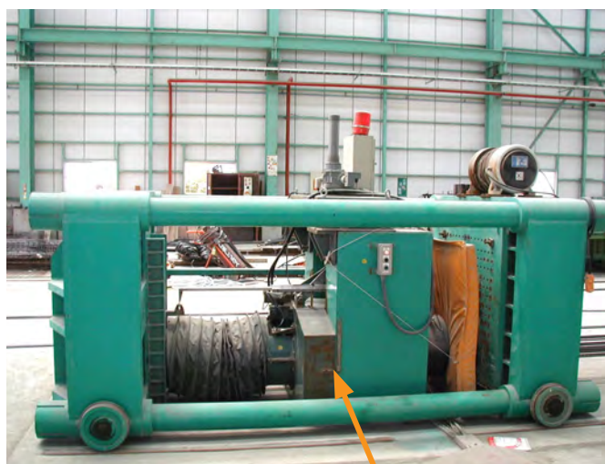
緊張ジャッキ
