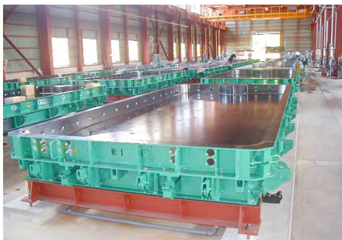
鋼製型枠(軌道スラブ)
