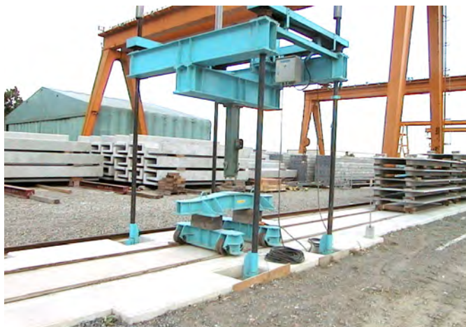
載荷試験装置
