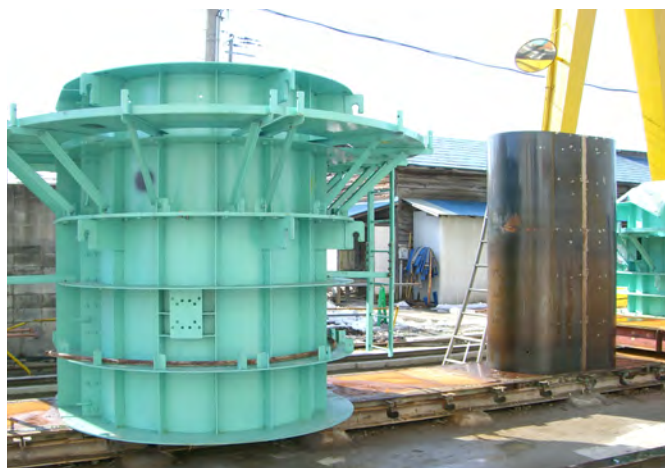
鋼製型枠(PCウェル)
