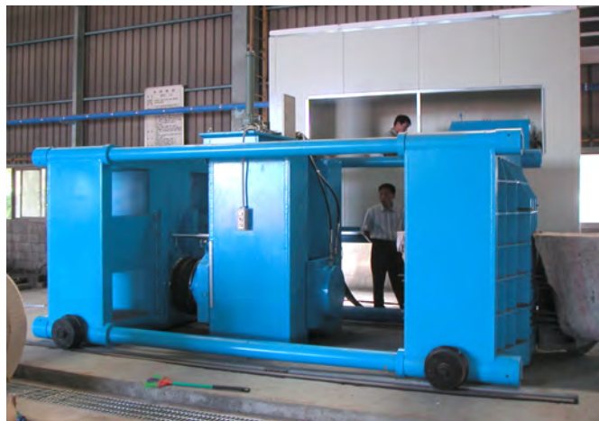
固定ポスト(緊張側)、緊張枠
